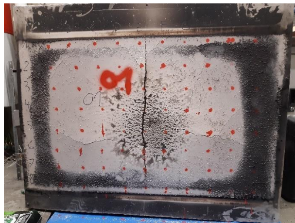
b) Rastr bodů pro měření hloubky kalcinace
