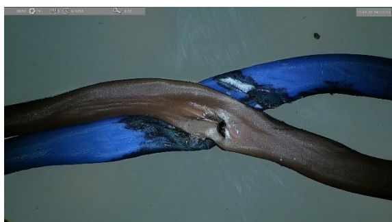
(A) Přitavený fázový a nulový vodič
