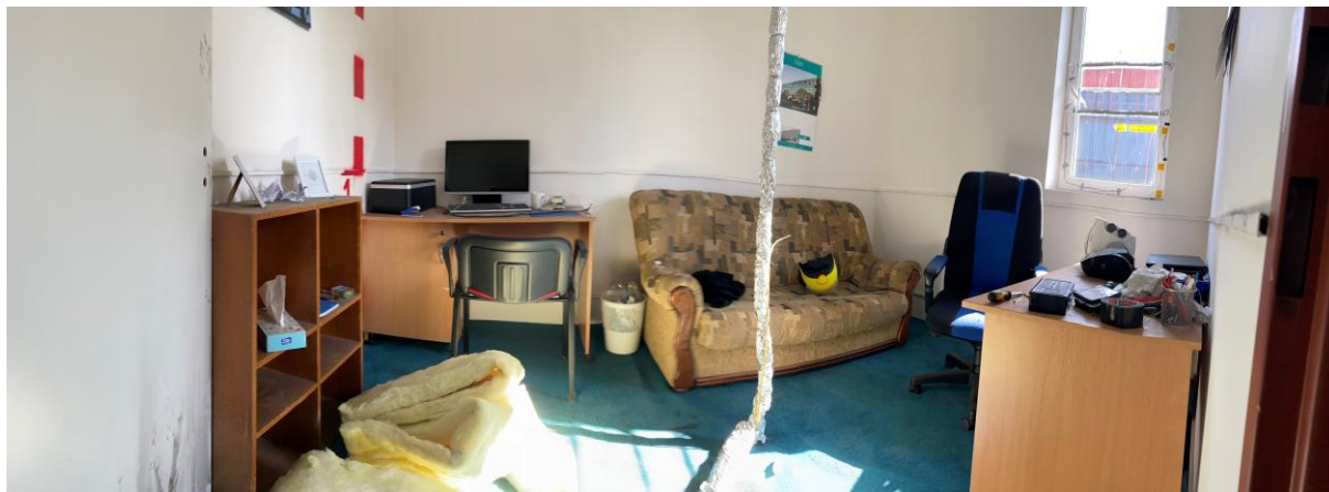
Obrázek č. 10.10 Pohled do místnosti před iniciací požáru v plastovém koši mezi sedací soupravou a pracovním stolem
