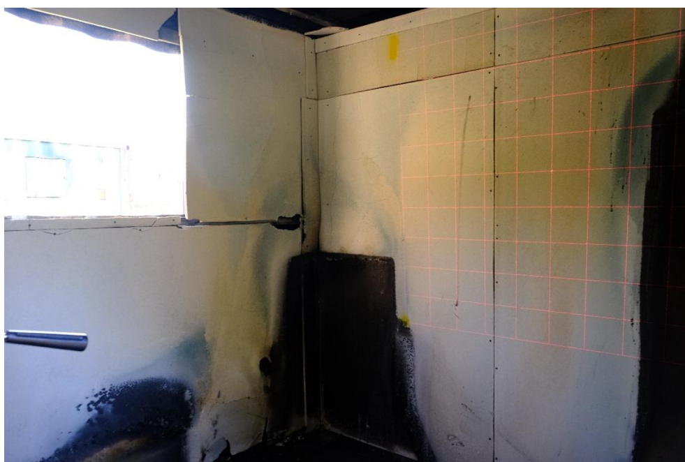
Obrázek 11.3 Vyznačený měřicí rastr vytvořený laserem
