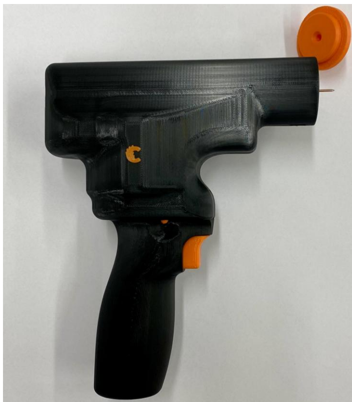
Obrázek č. 10.29 Aktuálně vyvinutý kalcinometr
