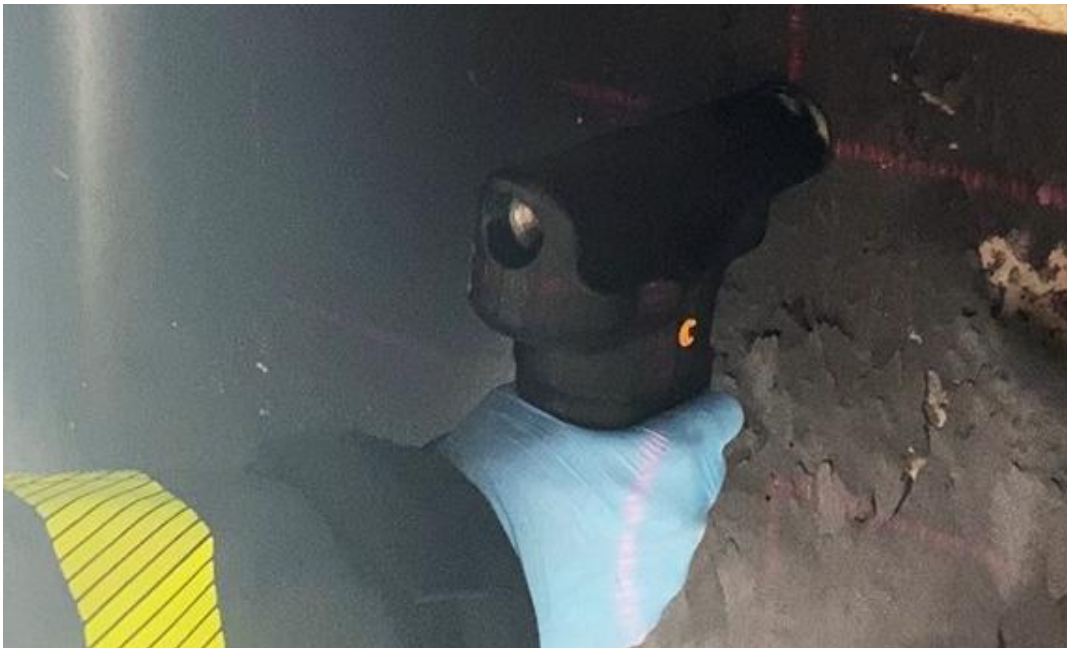
Obrázek 11.8 Měření pomocí kalcinometru na zobrazeném laserovém rastru
