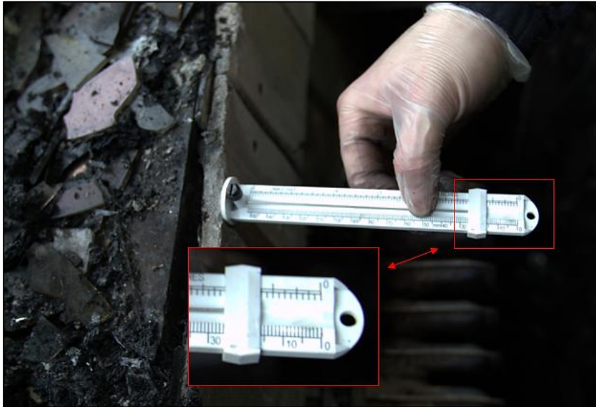
Obrázek č. 10.2 Ukázka měření, kdy je naměřeno 16 mm.
