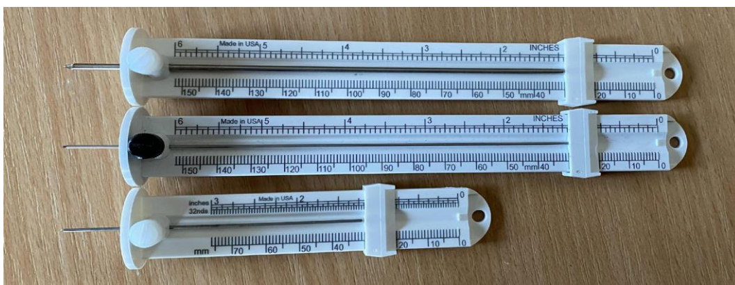
Obrázek č. 8.4 Dovezený technický prostředek pro měření tloušťky protipožárního nástřiku používaný pro měření hloubky kalcinace.
