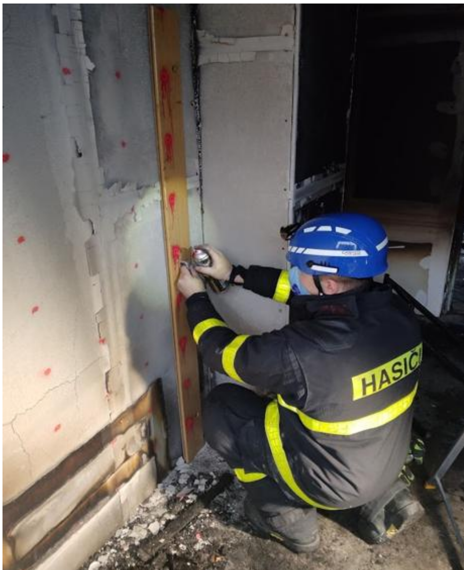
Obrázek č. 10.4 Vyznačení rastru na stanovenou měřící stěnu. Jedná se o SDK stěnu, u které bylo stanoveno kriminalistické ohnisko.
