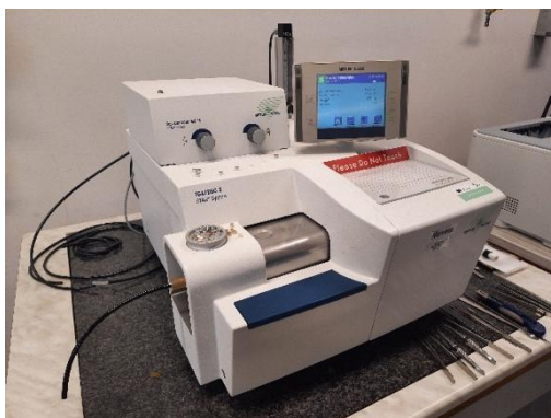
Obrázek 2.6 Zařízení METTLER TOLEDO TGA/DCS 2
