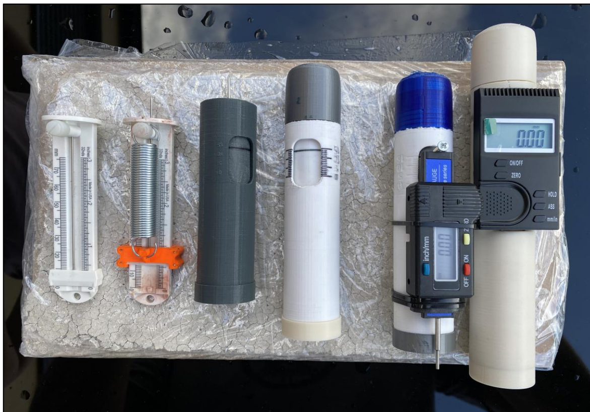
Obrázek č. 10.17: Vývoj kalcinometru z leva doprava
