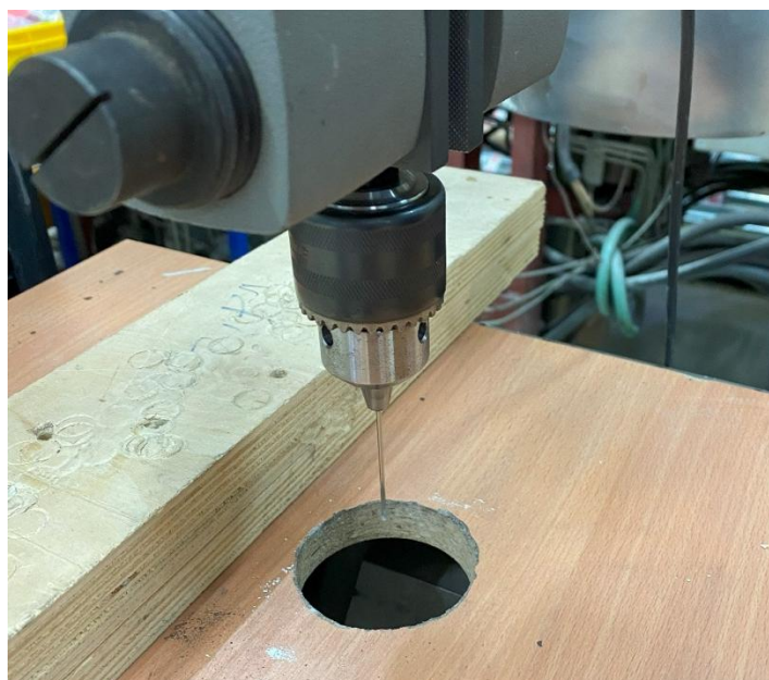
Obrázek 13.4 Bližší pohled na hrot nainstalovaný na elektromechanické trhačce
