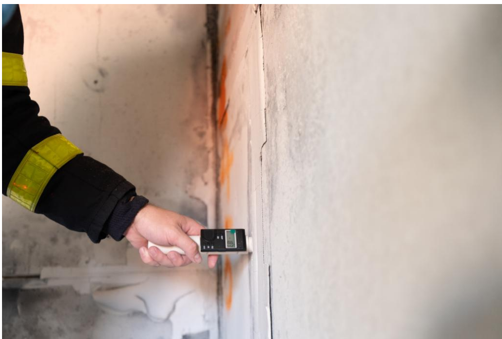
Obrázek č. 10.22 Ukázka měření s kalcinometrem
