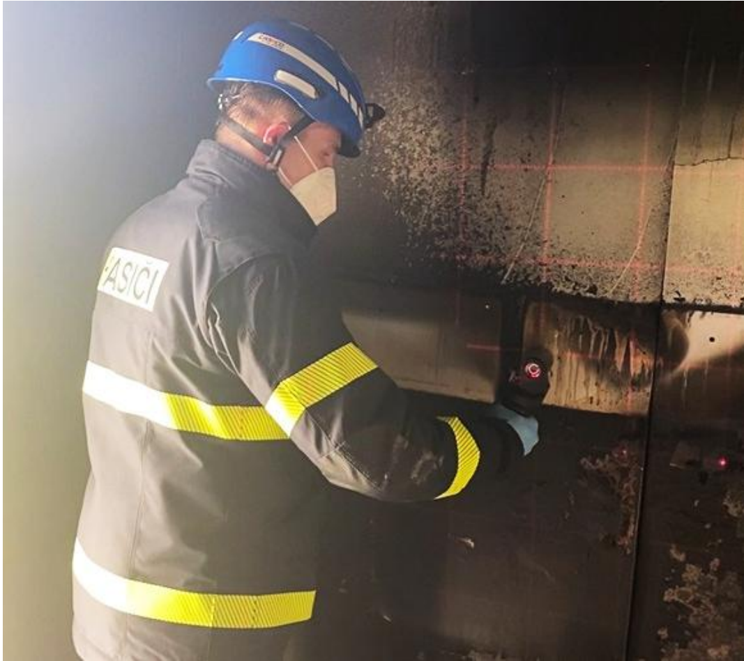
Obrázek 11.7 Operátor provádí měření kalcinometrem. Je postaven tak, aby nestínil zobrazení mřížky pomocí laseru
