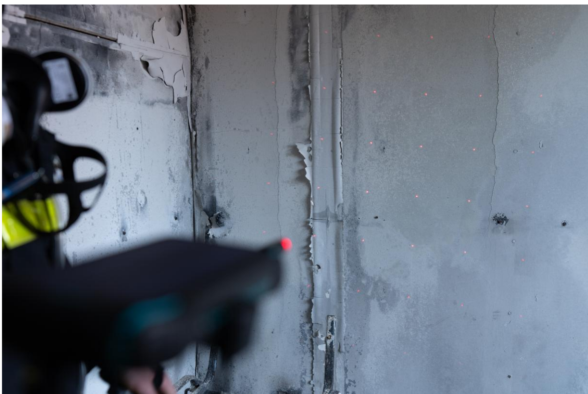
Obrázek č. 10.20 Pohled na zobrazený rastr na měřené SDK stěně.
