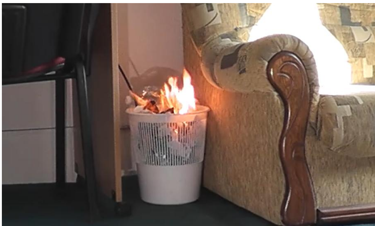
Obrázek č. 10.11 Pohled na plastový koš s odpadem těsně po iniciaci požáru.
