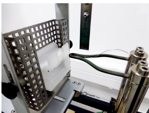
Obrázek 2.2 Zařízení pro zkoušení žhavou smyčkou
