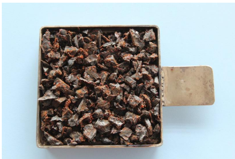
Obrázek 4.3 Vzorek zpolymerovaného tuku pro hodnocení na kónickém kalorimetru
