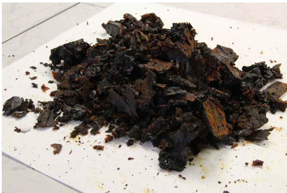
Obrázek 4.2 Celkové množství získaného zpolymerovaného tuku z jedné dvouformy
