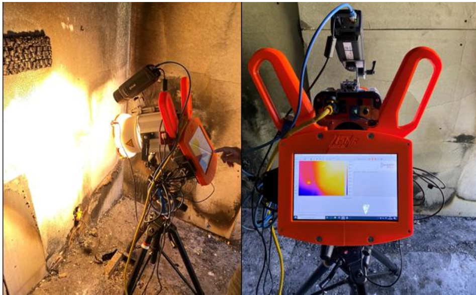
Obrázek 14.1 Příklad přístroje pro termografickou inspekci tepelně zatíženého sádrokartonu
