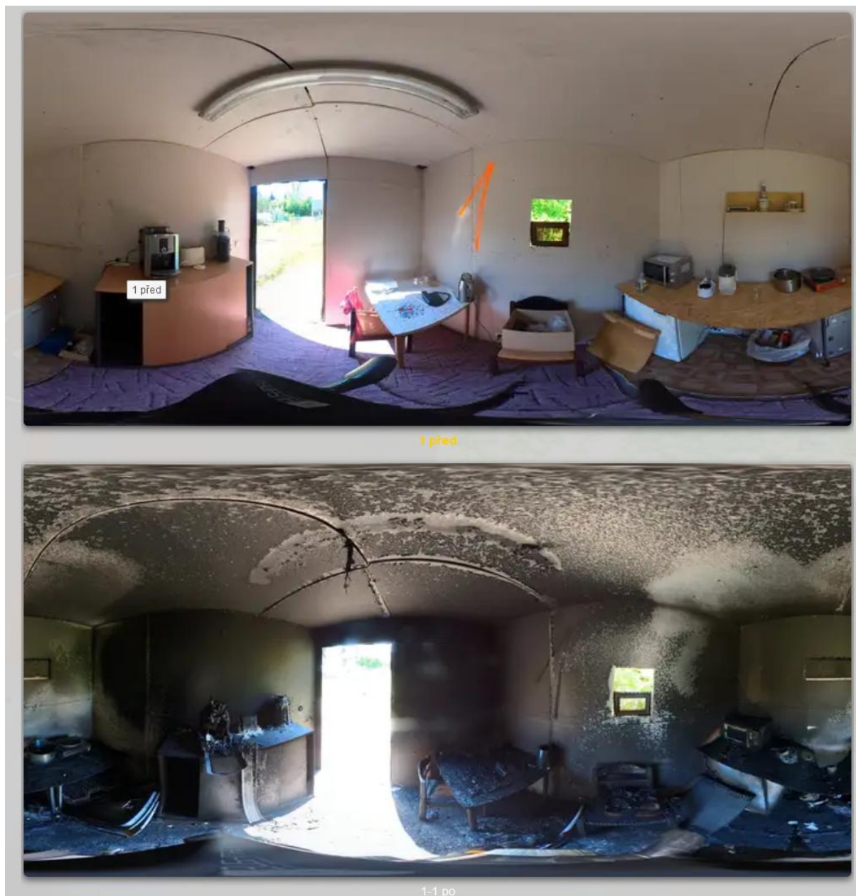
Obrázek 2 Prostor buňky před zapálením a po požáru
