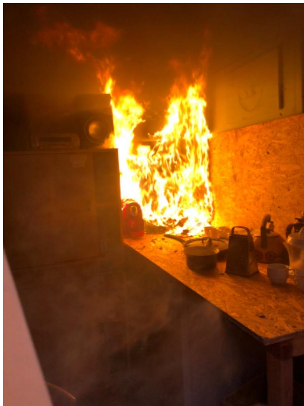
Obrázek 1 Rozvoj požáru v zapálené buňce
