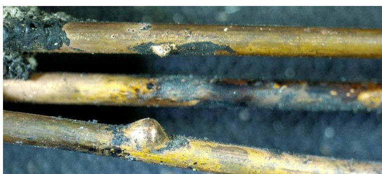
Obrázek 15 Zkratový nátav na pevných vodičích (Zdroj: HZS ČR)
