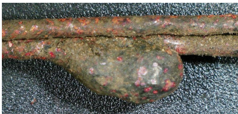
Obrázek 13 Tepelný nátav (Zdroj: HZS ČR)
