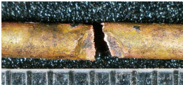
Obrázek 14 Tepelné a mechanické poškození (Zdroj: HZS ČR)
