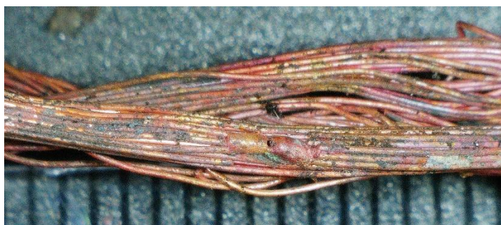
Obrázek 17 Zkratové nátaavy na slanéých vodičích (Zdroj: HZS ČR)
