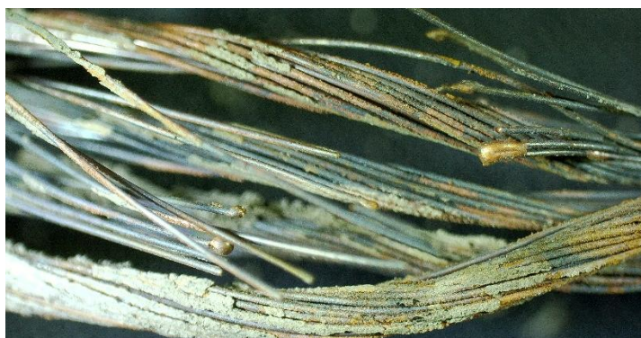
Obrázek 16 Zkratové nátaavy na slanéých vodičích (Zdroj: HZS ČR)
