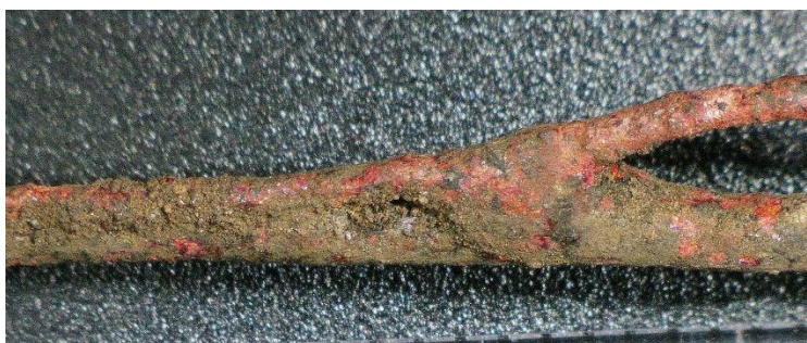
Obrázek 12 Tepelný nátav (Zdroj: HZS ČR)
